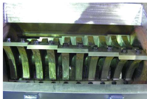
SG-1000F粉砕屋内部
