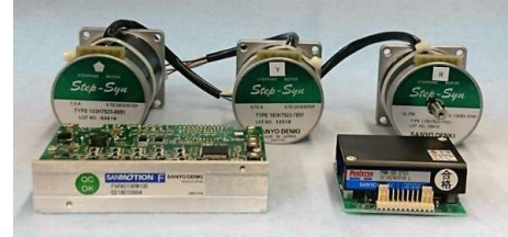
山洋電気製5相ステッピングモーター・ドライバーを採用
